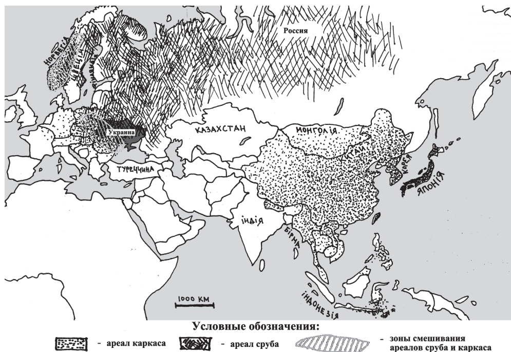
Ил. 1. Карта распространения срубных и каркасных конструкций деревянного зодчества на территории Евразии (рис. автора)
